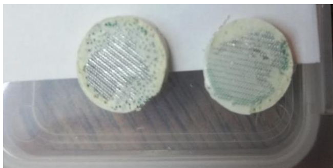
Figura 2. Discuri compozite PDMS:PZT cu raport masic 1:2 și electrozi de Al
