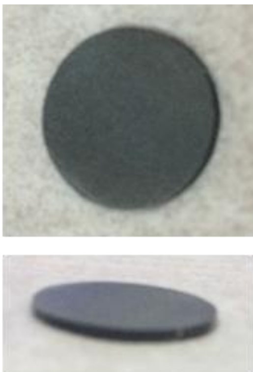
Figura 8. Imagine a unui disc din rășină ce a fost utilizat ca probă de măsură.
