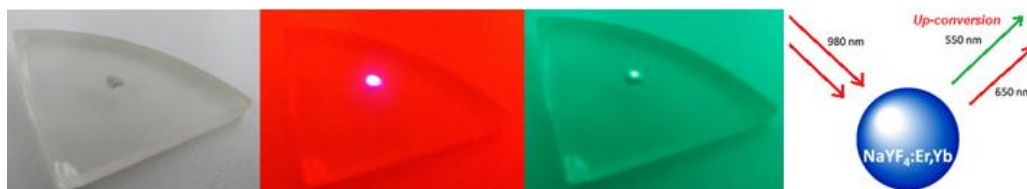
Figura 4. Imaginile optice ale pulberii nanocrystaline de \text{NaYF}_4(\text{Yb}, \text{Er}) observate la iluminare naturală (de zi) și sub pompaj la 980nm/200mW înregistrate printr-un filtru optic ce transmite în domeniul „roșu” (600-700 nm) și în domeniul „verde” (500-600 nm).
