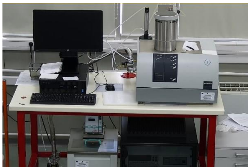
Figura 7. Stand de măsură pentru conductibilitatea termică.
