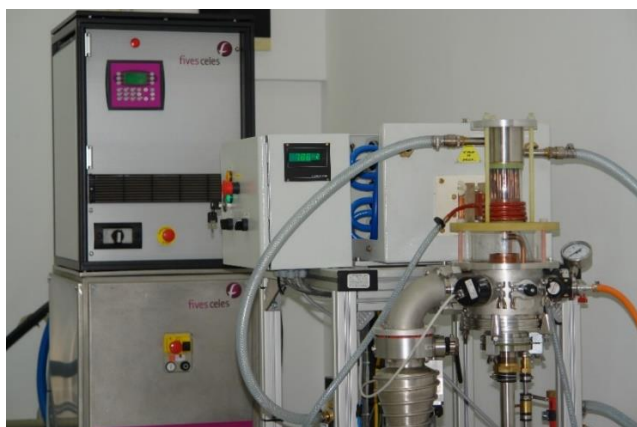
Figura 1. – Instalația de topire cu creuzet rece Fives Celes
