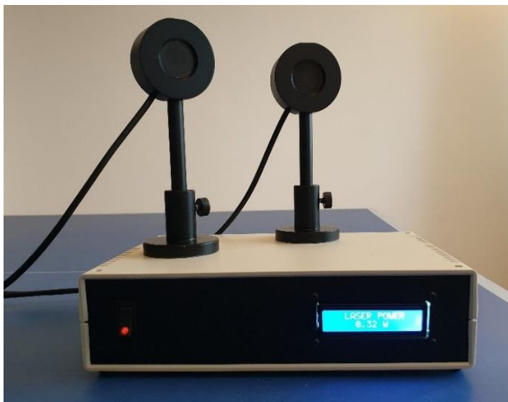
Figura 14. Kit de măsurare energie și putere laser, LT-01, format din LTM-01, LTDE și LTDP.
